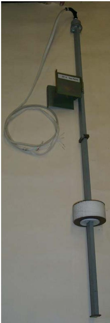
Поплавковый датчик уровня ДУ-4.
